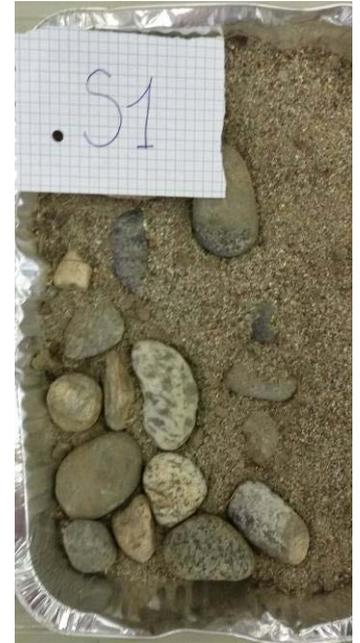
Figura 4 – Campione S1 sottoposto a setacciatura
