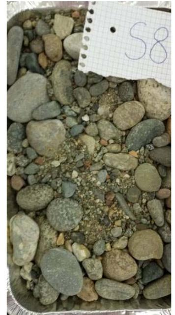
Figura 24 - Campione S8 sottoposto a setacciatura
