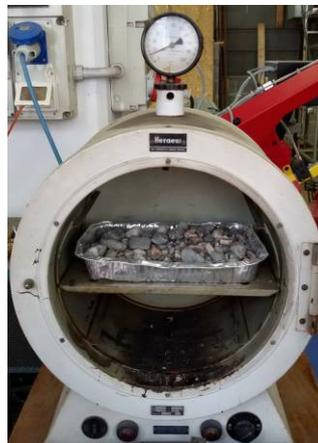
Figura 2 - Forno utilizzato per l'essiccazione dei campioni
