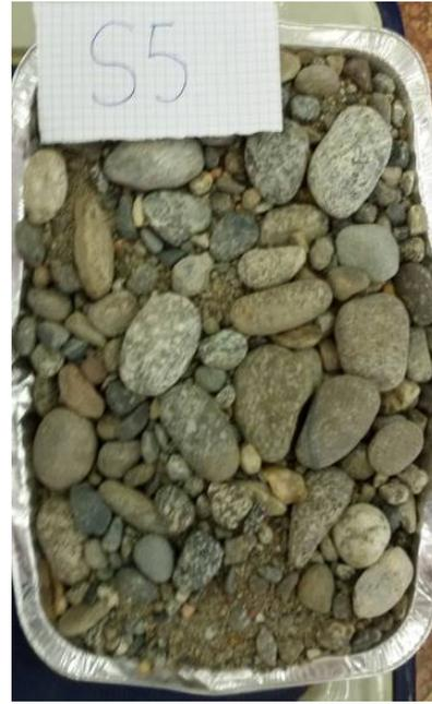
Figura 15 - Campione S5 sottoposto a setacciatura
