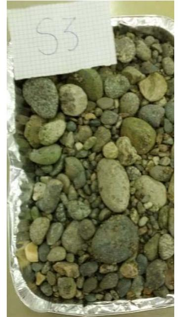
Figura 10 - Campione S3 sottoposto a setacciatura
