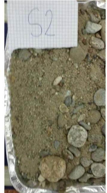
Figura 7 - Campione S2 sottoposto a setacciatura
