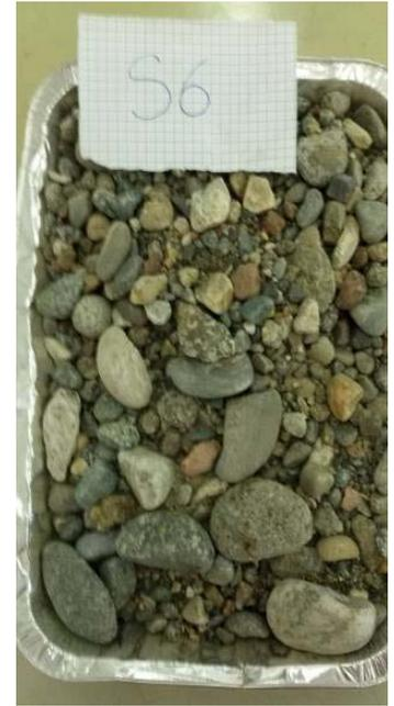
Figura 18 - Campione S6 sottoposto a setacciatura
